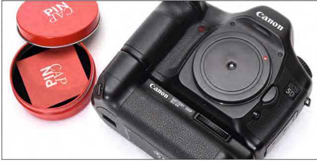
Lochblendenvorsatz vor einer (D)SL-Kamera (Lochdurchmesser: 0,22 mm, Brennweite: 35 mm, f 160)
