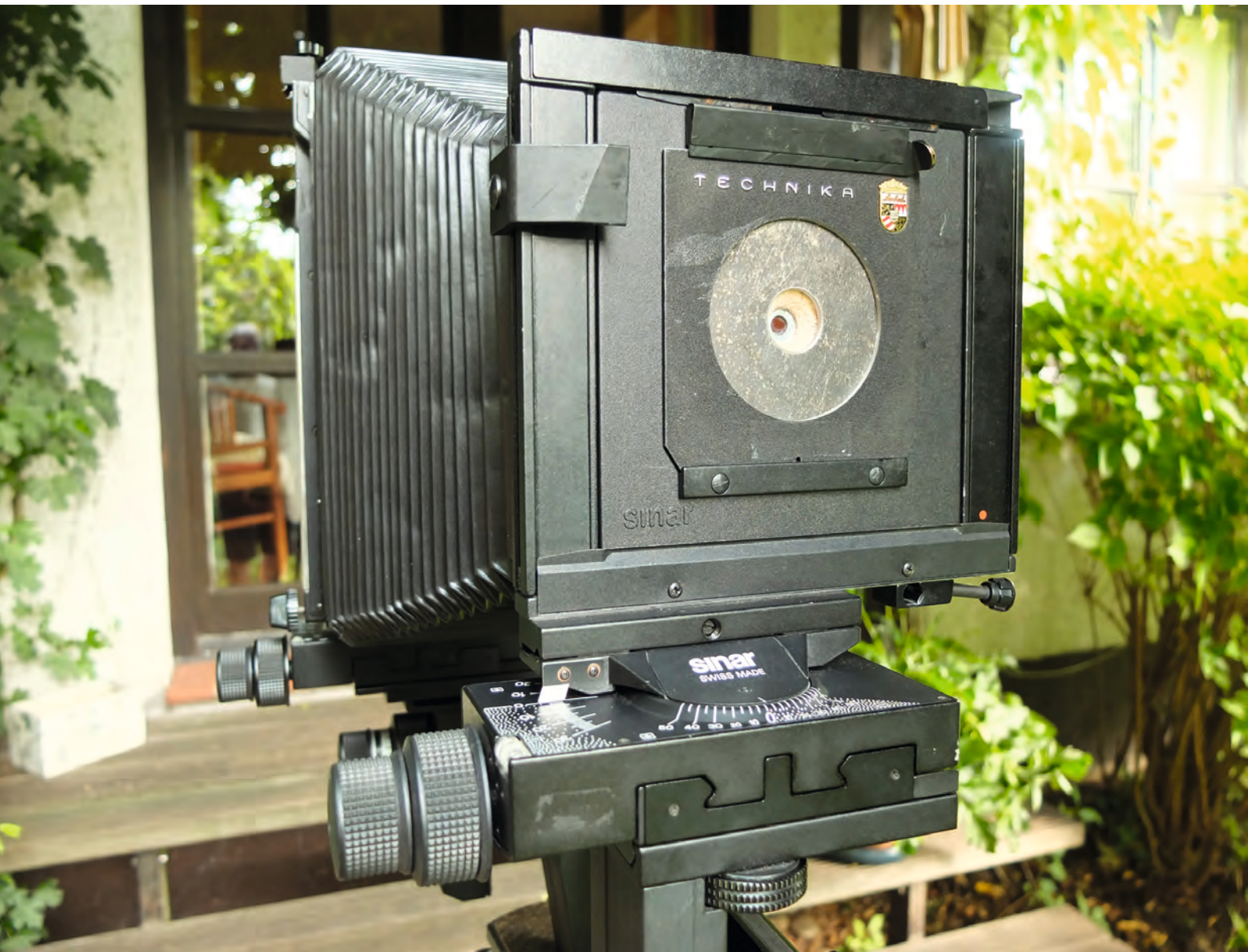
Selbstbau als Lochadapter auf einer Linhofplatte für 4 x 5- / 8 x 10-Inch-Kameras von K.-P. Gnaß, www.klauspetergnass.de
