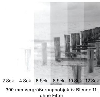
Hierbei wird das Fotopapier stufenweise abgedeckt und die Abdeckung immer um einen Streifen weitergeschoben. Dabei wird jedes Mal mit der gleichen Belich-
